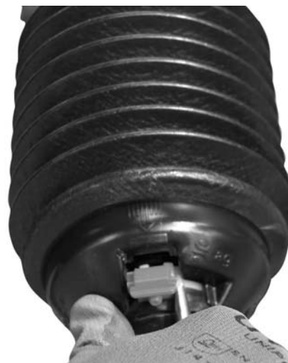
Rysunek 6.1: Otwieranie osłony wału przegubowego
