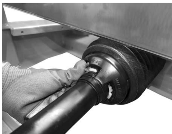
Rysunek 6.5: Zabezpieczyć osłonę wału przegubowego
